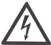
Рисунок 1.7 — Знак безопасности «Осторожно! Высокое напряжение!»
