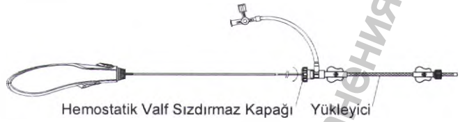
Şekil 8. Hemostatik valf sızdırmaz kapağının sabillenmesinin resimli açıklaması
