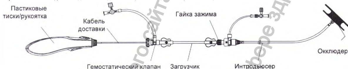
Рисунок 3. Система окклюдера ДМПП CeraFlex™ и интродьюсера SteerEase™
