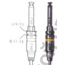
Имплантатов EV-GS. Имплантаты EV-GS могут применяться только при одном положении имплантата. Все бороздки на стержне обозначают длины имплантатов 8-11-15 мм и 6-9-13 мм, соответственно. Имплантат EV-GS имеет 6 шлицев. Одно из шлицев имеет больший размер и указывает положение «только в одной позиции» для дисперсионных абразивов Atlantis.
