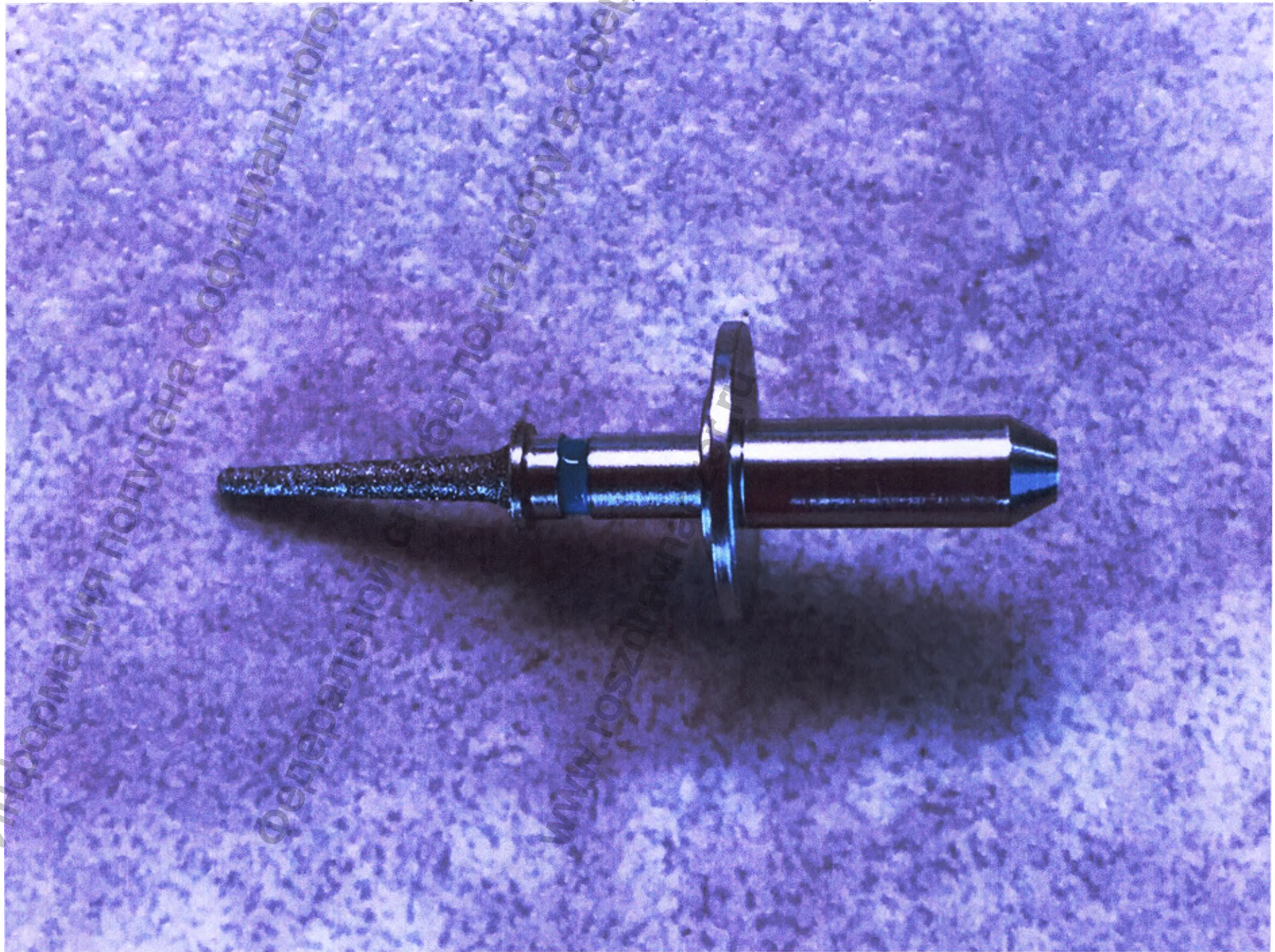
6.3. Фреза коническая (Conical, 1 синяя полоска).
