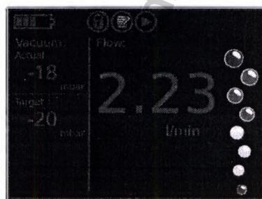
В условиях низкой освещенности экран переключается в ночной режим - с темным цветом основного фона.
