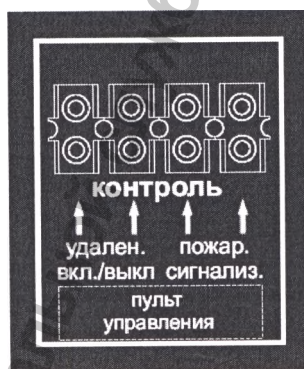
Рисунок 2.11 — Клеммная колодка удаленного управления
