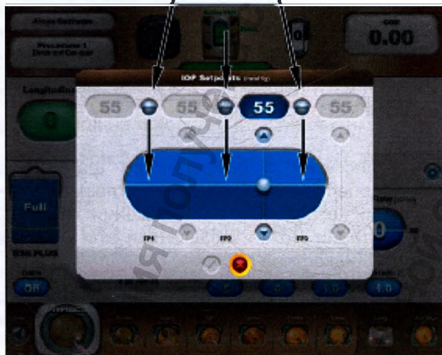
Рисунок 2-71 Заданное значение ВГД (фиксированное) для принудительной ирригации Active – Нажатие овальной клавиши отображения ВГД (mmHg или hPa) вызывает диалог «Заданные значения ВГД» (мм рт ст или гПа).
